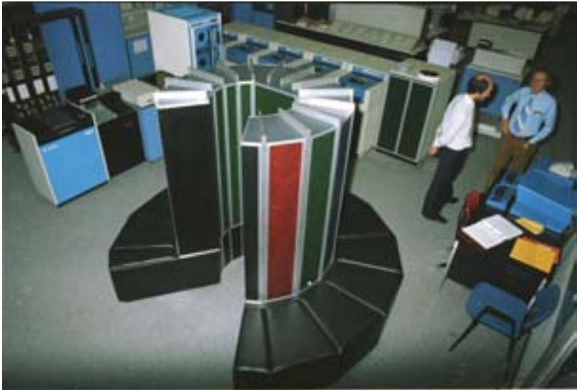
Abb. 10: Vektorrechner CRAY 1, installiert im Jahre 1980 im Rechenzentrum Garching (RZG) des MPI für Plasmaphysik, Garching.
