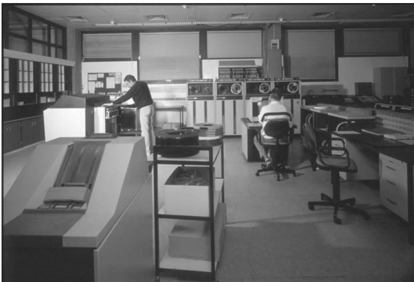
Abb. 8: CDC Cyber 7200; installiert im Jahre 1970, MPI für Radioastronomie, Bonn. Von links: Kartenstanzer, Zeilendrucker, Plotter, Bandeinheiten.
