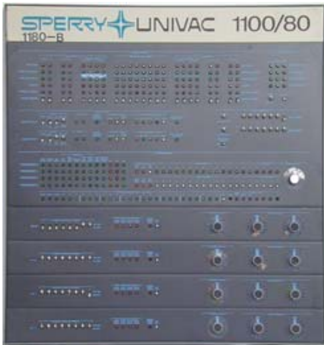
Abb. 11: Systemkonfigurationstafel einer Sperry Univac 1100/80; der Großrechner wurde im Jahre 1970 in der GWDG, Göttingen, installiert.
